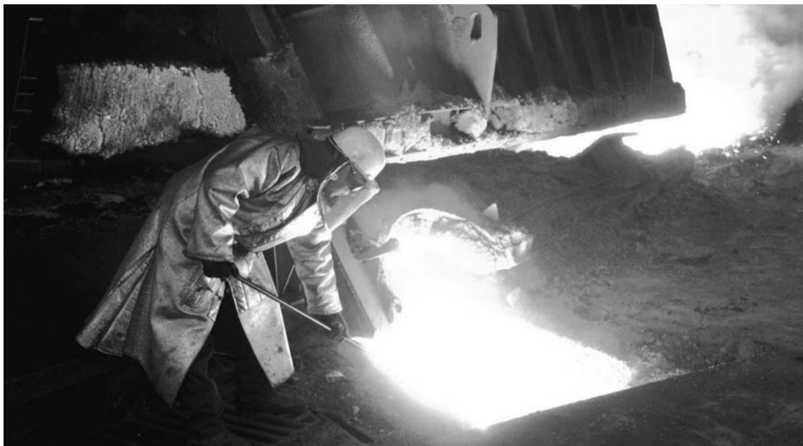
Un fondeur relevant un échantillon de fonte en fusion.
